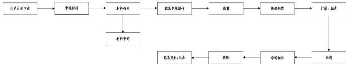
温度传感器热端制作主要包括切割、剥头、钻孔、焊芯、封头等工序；冷端制作主要包括烘烤、封胶等工序。
